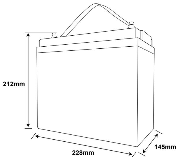
Dimensions avec les bornes L228\*W145\*H212 mm
